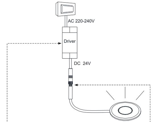
Nota: per garantire un funzionamento prolungato, utilizzare il box di alimentazione cod. 38BXxx67 contenente un driver con potenza da 12, 20 o 30 Watt con uscita 24 Volt per l'apparecchio di illuminazione e l'ingresso di alimentazione 230 volt.
